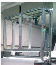
この度弊社はフィルム・不織布等検査のためのシート検査装置「玄さんR」を開発しました。ロール to ロールの搬送ラインに組み込むことでリアルタイム画像処理検査による省人化・省力化を実現します。従来の検査装置にはない「感度シミュレータ」などオフラインでのユーティリティソフトウェアを装備。生産ラインを止めることなく、検査感度の設定を行うことができます。シート検査装置導入をご検討の際は是非、弊社にご相談ください。
