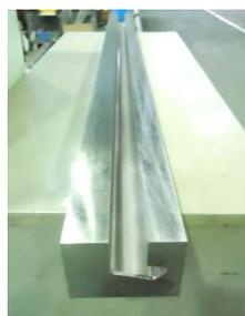
弊社では5面加工機等の加工機を複数台保有しており、東レグループや外部のお客様へ平面切削加工を中心とした各種大型部品の機械加工を提供しております。今回はその中でも特殊溝切加工を紹介します。左の写真のような長尺部材への単純な溝形状の加工はもとより、特殊プレーナーアタッチメントを使うことによりさらに奥まったL字型形状の溝を加工することができます。この加工技術はフィルム製膜設備用部品の製作で培われた技術でもあり、製品の品質向上と安定生産に役立っております。大型部品や長尺物の機械加工は是非弊社にお任せください。
