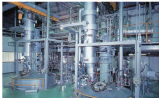
カラーベース製造装置の反応槽
