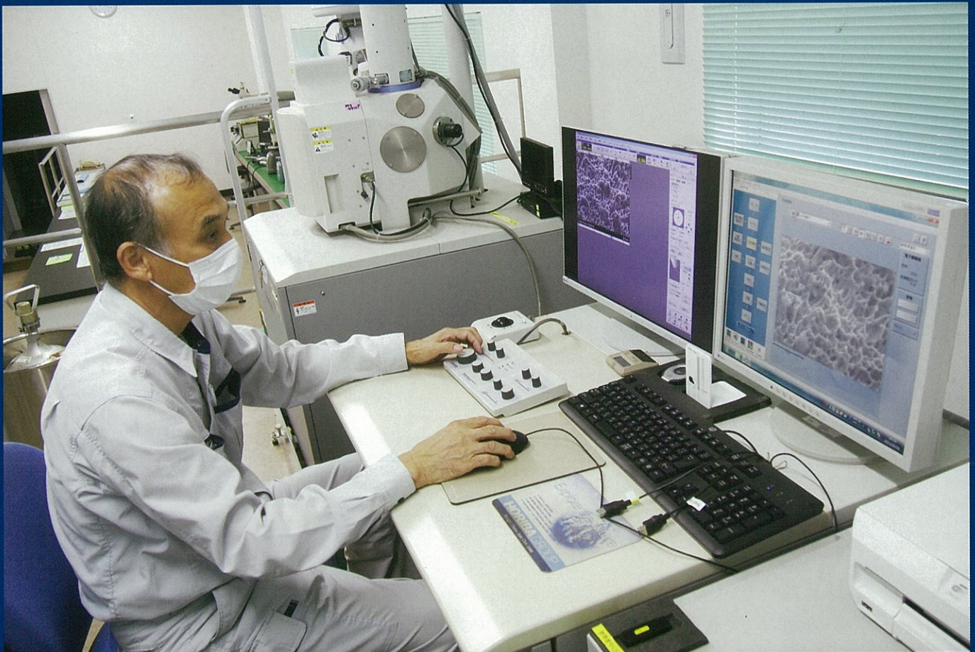
東レエンジニアリング中部(CTE)の総合保全センターにおける電子顕微鏡を使った材料検査
