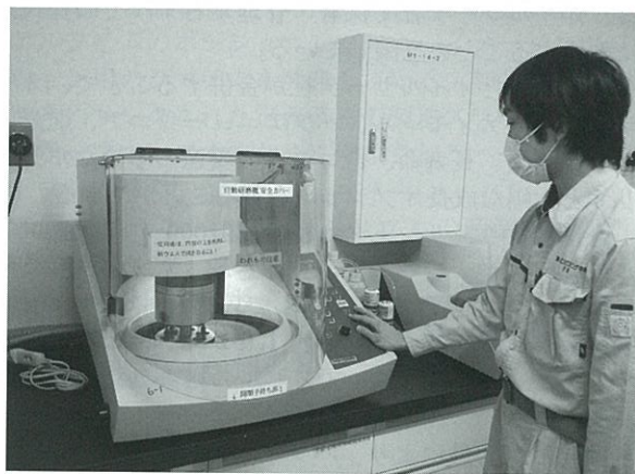
研磨・エッチングによる損傷検査
